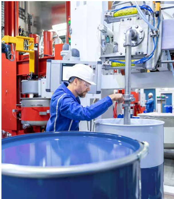
Produktion wärmeleitfähiger Siliconmassen am Standort Burghausen. Aus Qualitätsgründen wird die Befüllung der Transportfässer permanent überwacht.
