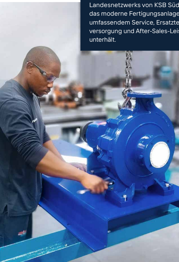
Germiston: Ein KSB-Mitarbeiter montiert eine Etanorm-Pumpe auf eine Grundplatte.
