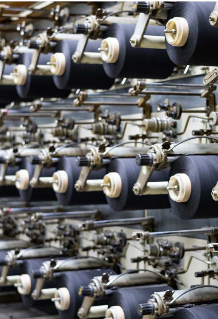
Aufwicklung Zwirrspulen in der Fadenstreckanlage.
