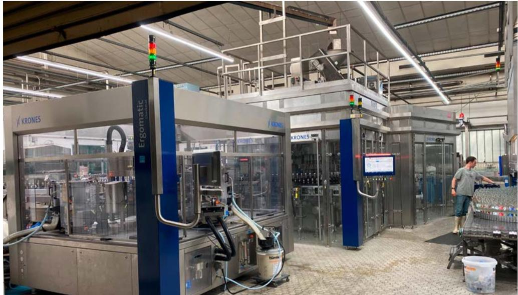
Die neue Abfüllanlage ist eine technologische Spitzenleistung und verfügt für HERRNBÄU über beeindruckende Leistungsdaten. Mit einer Abfüllkapazität von 36.300 Flaschen pro Stunde, was zehn Flaschen pro Sekunde entspricht, und einem Volumen von 16.000 Litern pro Stunde setzt die Anlage neue Maßstäbe in puncto Effizienz und Produktivität. Der Abfüller dreht sich mit einer Geschwindigkeit von 1,2 m/s oder 4,2 km/h und hat einen Durchmesser von drei Metern.
